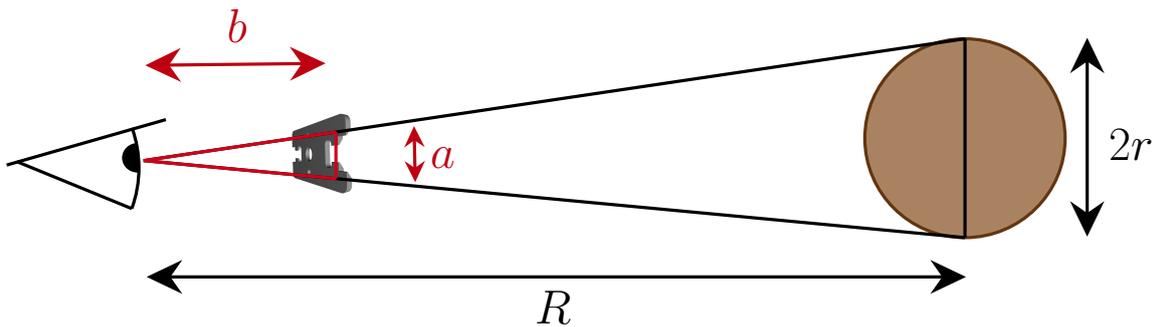
1. On imagine que, comme sur le dessin, l'arbre apparaît à l'observateur exactement du même diamètre apparent que l'encoche du relascope. Quelle relation entre  $a$ ,  $b$ ,  $r$  et  $R$  donne le théorème de Thalès ?
